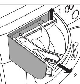
Если требуется ополоснуть распределитель моющих средств, приподнимите и извлеките его как показано на рисунке. Поставьте распределитель под струю воды на несколько минут.
