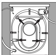
Транспортировочные винты должны быть удалены до того, как вы начнете пользоваться машиной. Образовавшиеся отверстия закройте пластиковыми заглушками (входят в комплект поставки машины). **Внимание!** Закупорите пробкой (входящей в комплект) 3 отверстия, в которых была размещена вилка и которые расположены на задней части стиральной машины, снизу.
